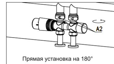
Затяните соединительный колпачок A2 с помощью инструмента T1 или T3
