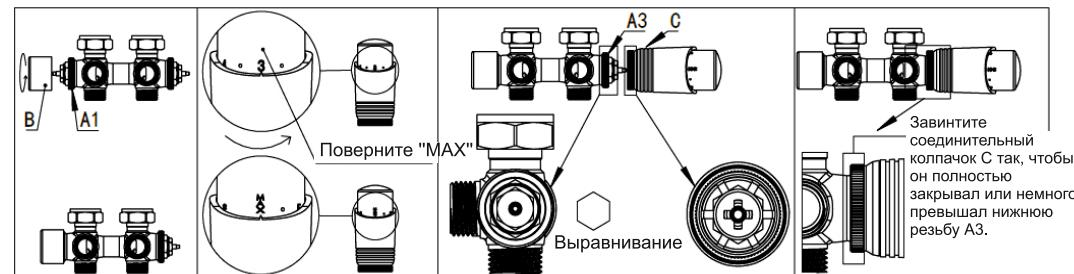
Проверьте расположение вашего радиатора и впускного / выпускного патрубка, если он установлен прямо на 180° (трубы выходят из пола) или под углом 90° (трубы выходят из стены).
