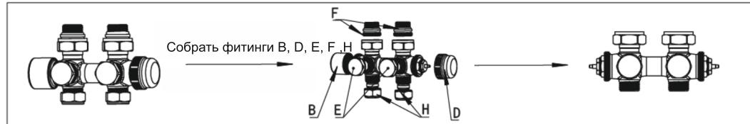
Установите деталь B со стороны корпуса клапана A1. Вкручивайте деталь B до тех пор, пока она не закроет резьбу. Не завинчивайте слишком сильно, иначе клапан не будет работать нормально.
